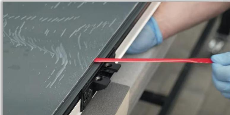
6. Positionnement et pression sur le panneau contre le vantail, ce qui immobilise les tôles grâce au ruban adhésif. Il est recommandé d'utiliser des rouleaux.
