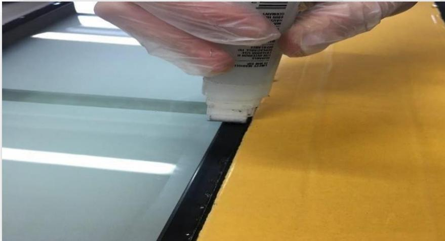
Une fois toute la préparation pour le collage des panneaux à recouvrement terminée (processus décrit dans les points précédents), retirez la couche protectrice du ruban juste avant de coller la partie intérieure.
