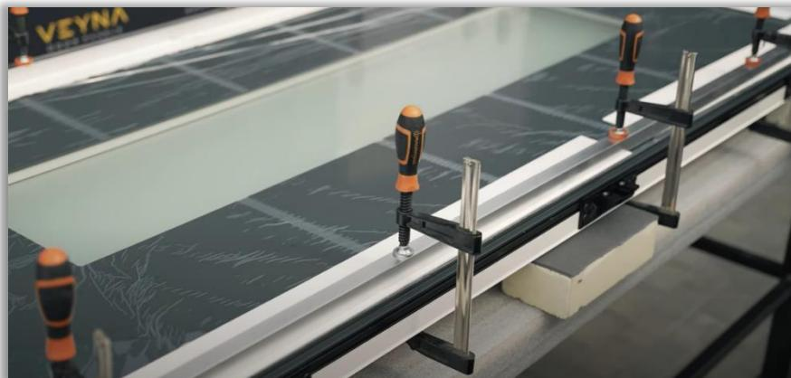
**3. Collage de la face intérieure du panneau** (dans le cas d'un panneau à recouvrement à deux faces). Appliquer la colle SIKAFLEX 221 en zigzag sur les profils verticaux et horizontaux en laissant un espace libre d'environ 20 mm à partir du bord extérieur du vantail afin d'éviter que la colle ne s'échappe à l'extérieur de la structure.
