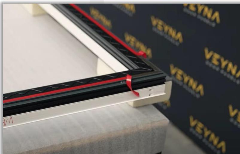
4. Positionnement correct du revêtement en tôle par rapport au vantail de la porte.
