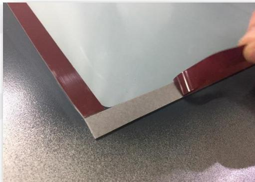
Après avoir assemblé la tôle intérieure avec les autres parties de la structure, appuyez uniformément et avec force sur la surface à assembler à l'aide d'un ruban adhésif.
