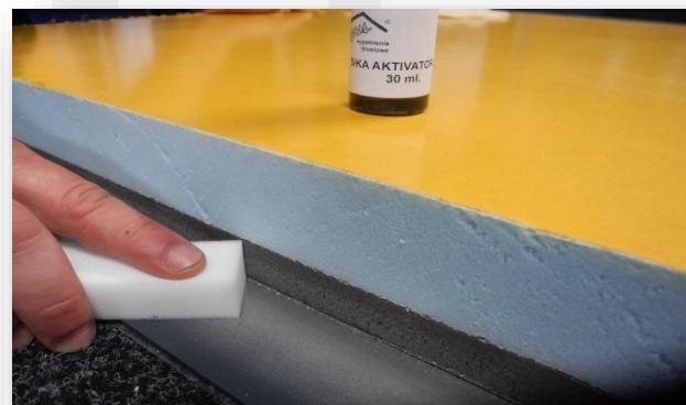
Après avoir activé l'aluminium, appliquez le produit Sika Primer 206G+P sur les éléments collés, en veillant à ne pas salir les autres éléments du panneau ou du vantail.
