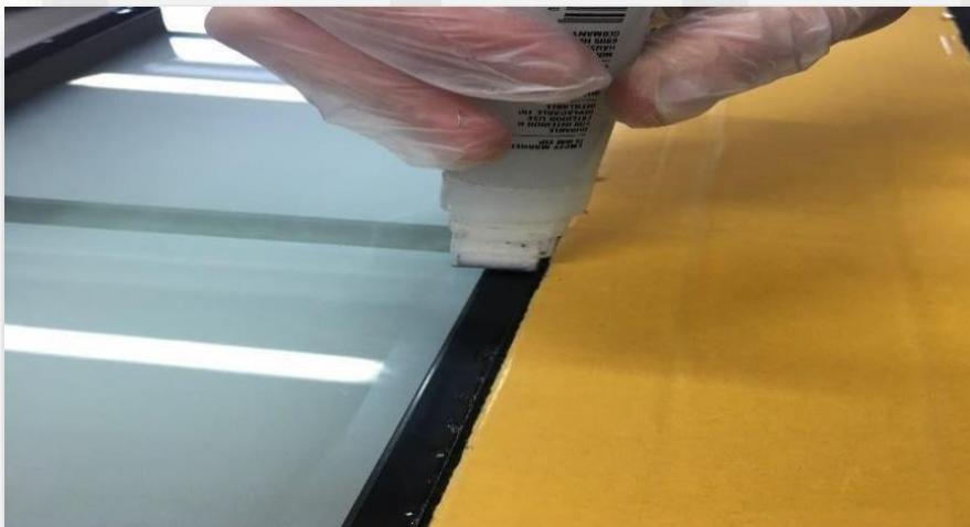
Nach dem gesamten Vorbereitungsprozess zum Verkleben der Oberflächen der Aufsatzpaneelen (der Prozess wurde in den vorherigen Unterpunkten beschrieben) entfernen wir kurz vor dem Verkleben des Innenteils die Schutzschicht vom Klebeband.
