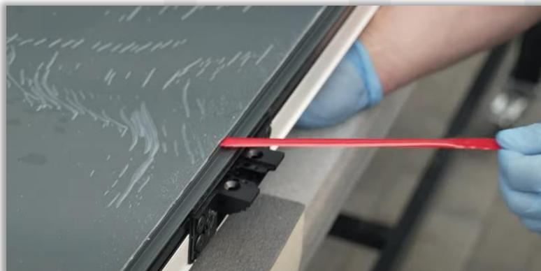
6. Das Paneel wird auf den Flügel aufgesetzt und festgedrückt, wodurch die Bleche dank des Klebebands fixiert werden. Es wird empfohlen, Rollen zu verwenden.
